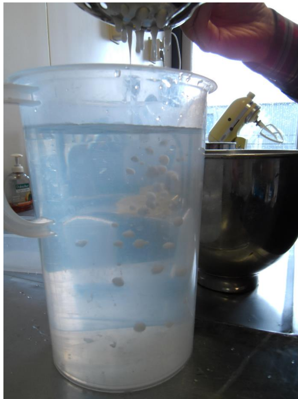
Figuur 8 Test met alginaat om vanuit bloempap vezels te maken
